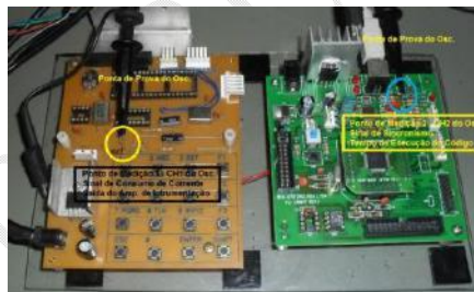
Figura 13 - Kits com as pontas de prova do osciloscópio fixadas em pontos estratégicos.
