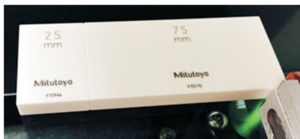
Figura 8 - Medição por Sistema óptico - união de Blocos Padrão de Cerâmica de 25mm+75mm
