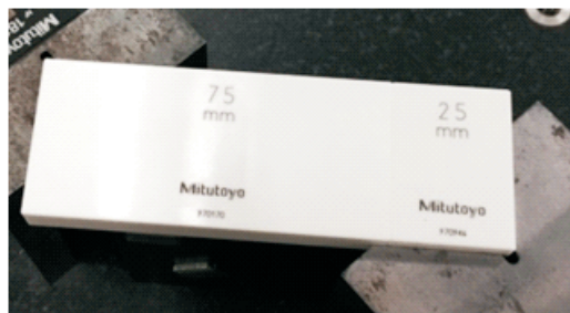
Figura 5 - Medição por Sistema de contato - união de Blocos Padrão de Cerâmica de 70mm+25mm
