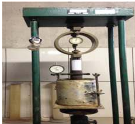
Figura 5: Corpo de prova do CBR posicionado na prensa para ruptura. Fonte: Os Autores, (2017).
