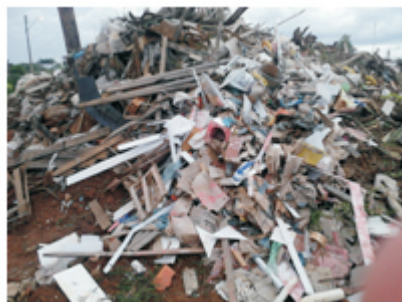
Fig. .3 - Foto de resíduos da construção civil no aterro da cidade composição de tijolo bloco de cimento/concreto/cerâmica e terra.
