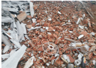
Fig. .2 Foto de resíduos da construção civil em terreno da cidade composição telha restos de equipamentos domésticos, plásticos, tijolo, bloco de cimento e terra.
