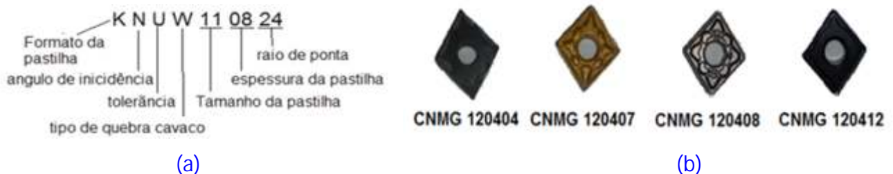
Figura 1. Ferramentas de corte de Metal Duro (a) Classificação ISO e (b) Tipos Comerciais
